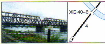
Железная дорога, железно-дорожный мост (ЖБ — железобетонный; 40 — длина, 6 — ширина в метрах), станция и насыпь (4 — высота в метрах)
